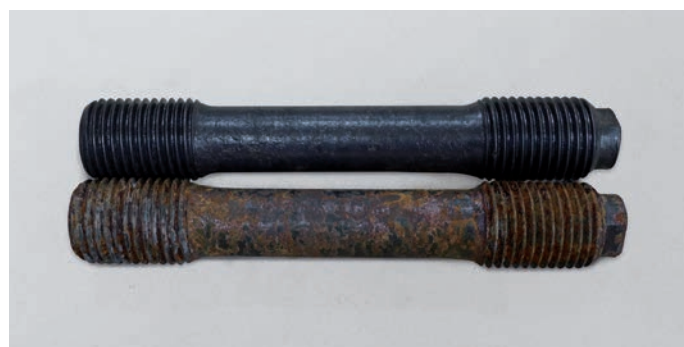
Vis avant et après le nettoyage
